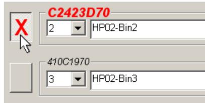
正しいセンサーが選択されると、そのセンサーの内部設定パラメータが、設定ページ選択時に読み込まれ、センサーID、アドレス、および名前がページの上部に表示されます。
