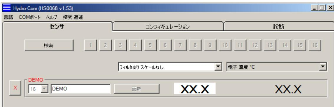
RS485 ネットワーク上で検出されたセンサーは、以下のアクティブセンサーボタン上に表示されるアドレス番号により識別されます。同時に最大 6 台までのアクティブセンサーが、以下のように Hydro-Com に表示できます。
