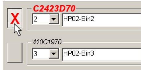
일단 올바른 센서를 선택했다면 해당 센서에 대한 내부 구성 매개변수는 구성 페이지를 선택할 때 확인되며 센서 ID, 주소 및 이름은 페이지 상단에 표시됩니다.
